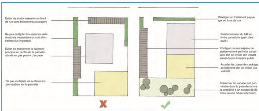
**. Limiter les surfaces imperméabilisées :** Conserver un maximum de surfaces de sol naturel en fonction des besoins : favoriser un traitement des surfaces avec des revêtements poreux (roche concassée, dalles alvéolées, sol enherbé, stabilisé...)
